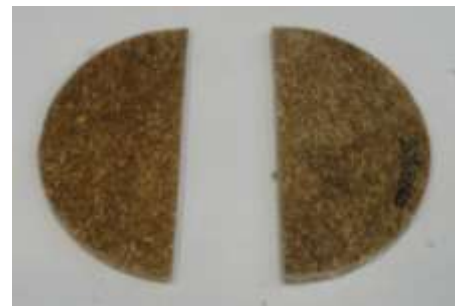
b) Probeta de composite con matriz polimérica reforzada con fibras
